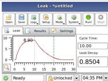
Step 2 : 测试过程分为三个阶段，充气(Charge)、平衡(Settle)、测试(Test)，前面两个时间都需要预测试抓取适当条件，如与供应气体、填充体积无法匹配，将导致充气不完全或是不平衡，导致测试失败。结果将会直接显示于面板上。
