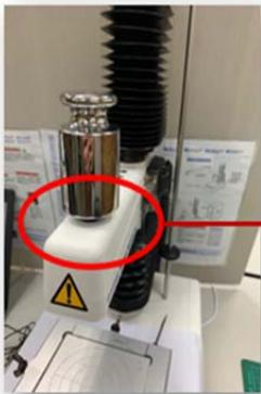
1. 将砝码放置校准平台即可做力量校正
